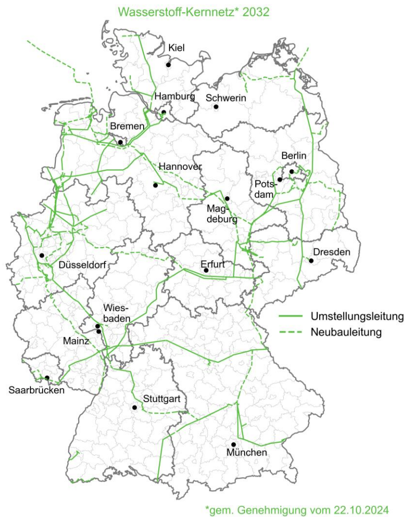
Abbildung 19: Genehmigte Planung für Wasserstoff-Kernetz [Quelle: FNB Gas 2024]
