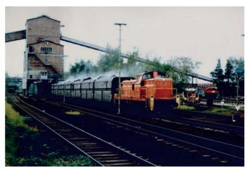
Die weitere Verbindung zum Bayernwerk wurde auf dem Schienenweg hergestellt. Vom Hochbunker transportierten Züge die Kohle in das Kraftwerk. Auf diesem Foto ist eine der 1000-PS-starken Diesellokomotiven zu sehen, jeder der Wagons fasste 50 Tonnen Braunkohle.
